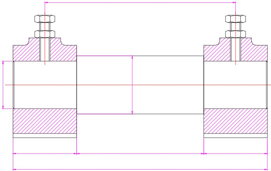
Für Rolle mit Nabenbreite 118mm und Achsdurchmesser 55mm und 60mm.
